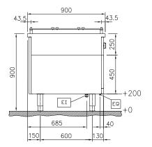
Electrical inlet (power) Equipotential screw EQ
